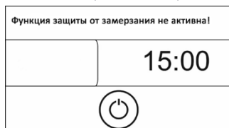
Рис. 8 Вид дисплея при выключенном контроллере (режим STAND-BY), при котором функция защиты от замерзания неактивна.
